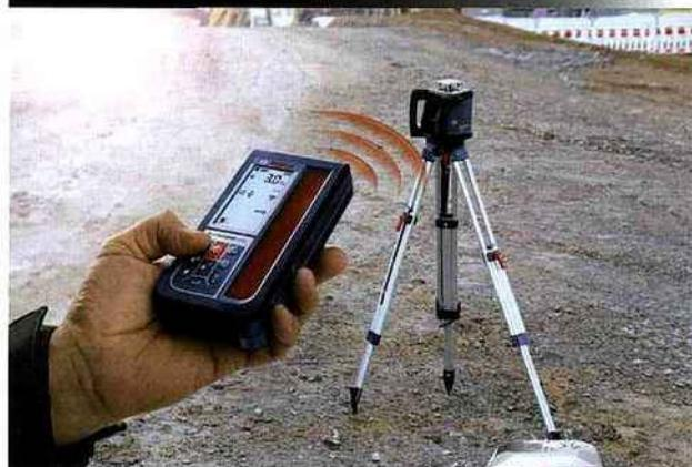
Bosch lance un nouveau laser rotatif à pente pour tous les travaux extérieurs de nivellement : le GRL 500 HV Professional. Polyvalent, il permet une mise à niveau automatique horizontale et verticale et offre une portée de travail jusqu'à 500 m de diamètre. Il compense des inclinaisons de pente de  $\pm 10\%$  ( $\pm 5^\circ$ ). En mode horizontal, le pourcentage de la pente souhaitée peut
